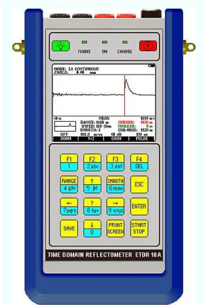
Die ETDR 10A-1 war entwickelt für schnelle und genaue Fehlerortung und Qualifizierung von symmetrischen Aderpaaren mit dem Impuls-Echo-Verfahren. Die vielseitigen Betriebsarten ermöglichen die genaue Ortung von Unterbrechungen, Wackelkontakten und nasse Kabelteilen.
