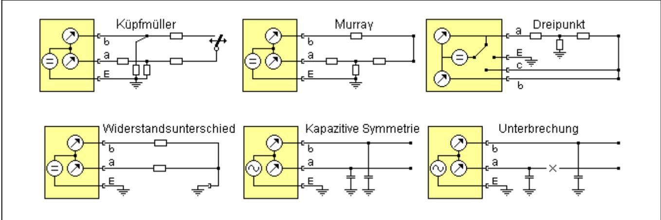
**SPEZIFIKATIONEN DER KABELPARAMETERMESSUNGEN**
